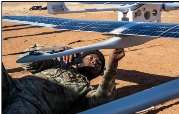
Figura 2-3. Un soldado de la 2. a Fuerza Operativa Multidominio realiza una inspección previa al vuelo en un UAS durante el ejercicio «Arcane Thunder 25». 17
