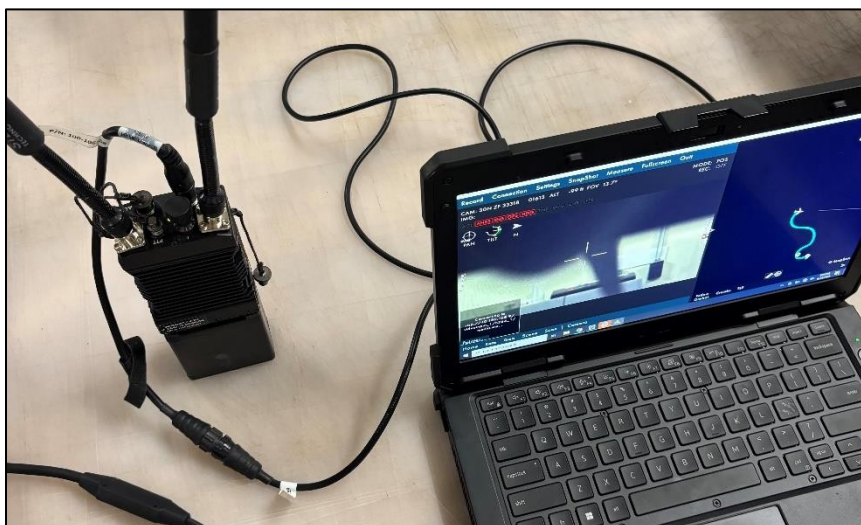
Figura 16. Stalker GCS conectado a AN/PRC-169 para la transmisión de señales MANET.
