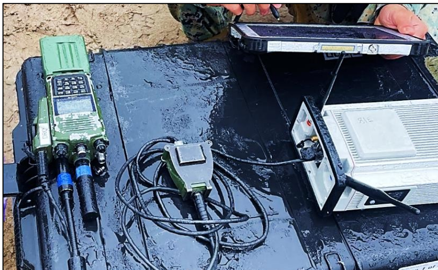
Figura 14. SkyRaider GCS conectado a AN/PRC-163 para la transmisión de la red TSM.
