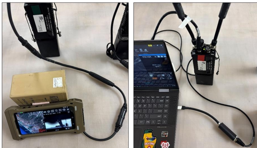
Figura 17. Dispositivos ATAK (izquierda) y WINTAK (derecha) recibiendo la señal del sUAS a través de la MANET AN/PRC-169.
