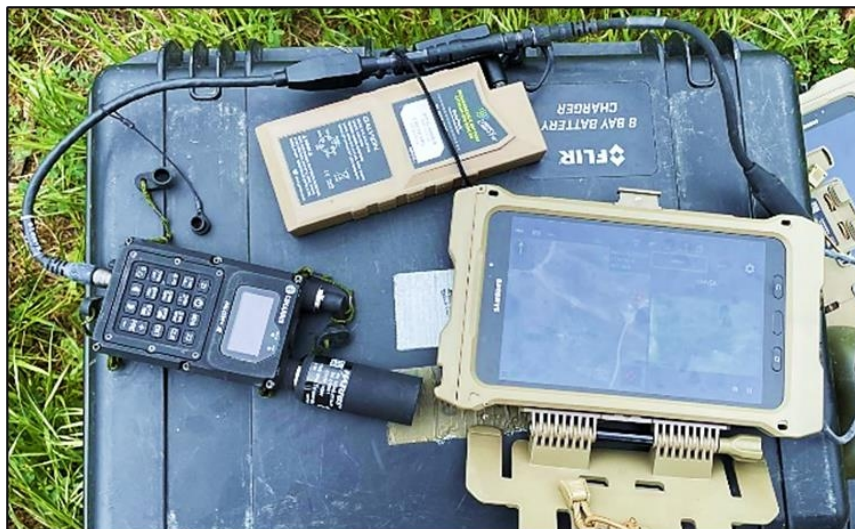
Figura 15. Dispositivo TAK conectado al AN/PRC-165 para sUAS VDL.
