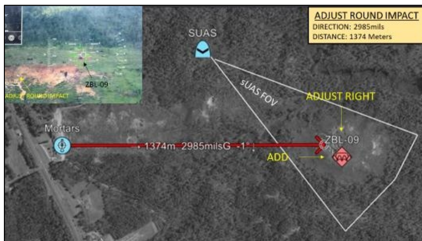
Figura 20. Cálculo del ajuste de la ronda utilizando una herramienta digital de línea y rumbo.
