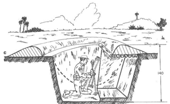
Fig. 13. Adaptación de un embudo para el combate.
