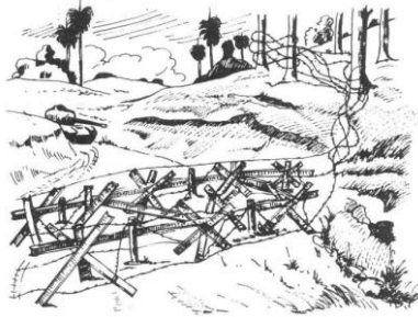
Obstáculos antitanques con erizos con vigas o carriles de acero.
