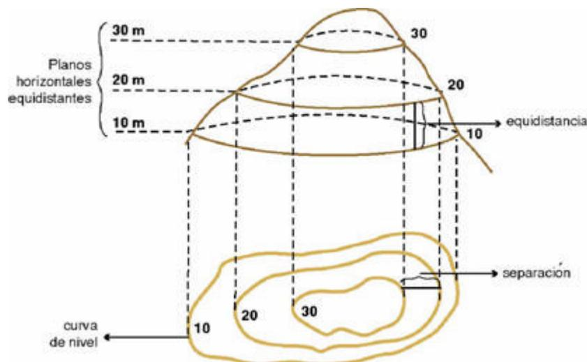
Figura 72: Estructura del sistema de curvas de nivel.
