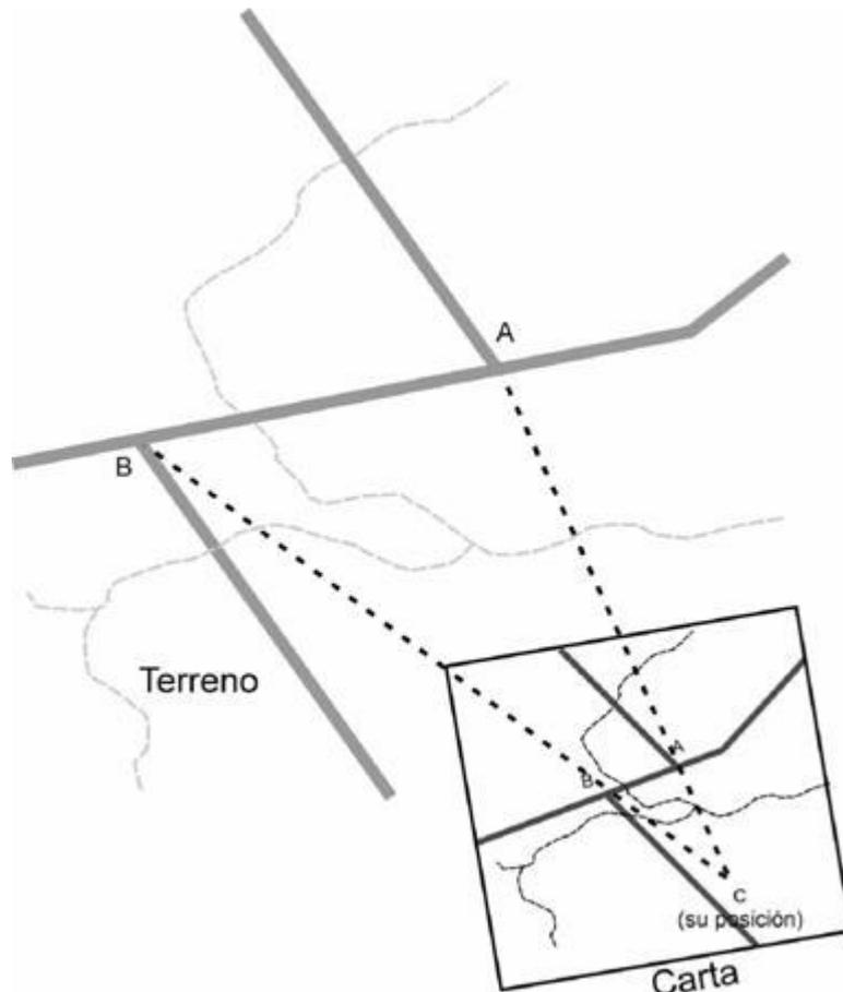
Figura 127: Método de la intersección inversa.
