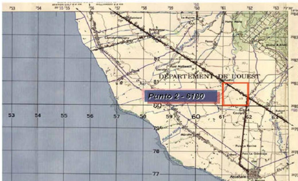
Determinación de las coordenadas de un punto con precisión 1000 metros (Fig. 63)
