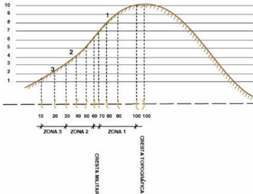
Figura 103: Determinación de la cresta topográfica y militar.
