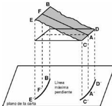
Figura 95: Línea de máxima pendiente en curvas paralelas.
