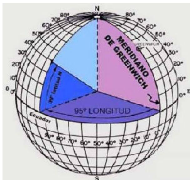
Grillado para la determinación de la Latitud y Longitud de un punto (Fig. 49)
