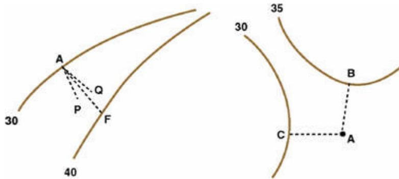
Figura 96: Línea de máxima pendiente en curvas no paralelas.
