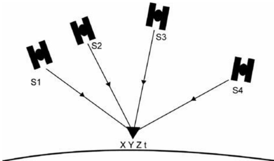
Figura 120: Determinación de la posición.
