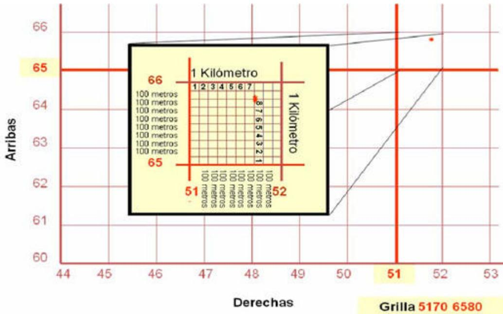
Determinación de las coordenadas de un punto con precisión 10 metros (Fig. 64)
