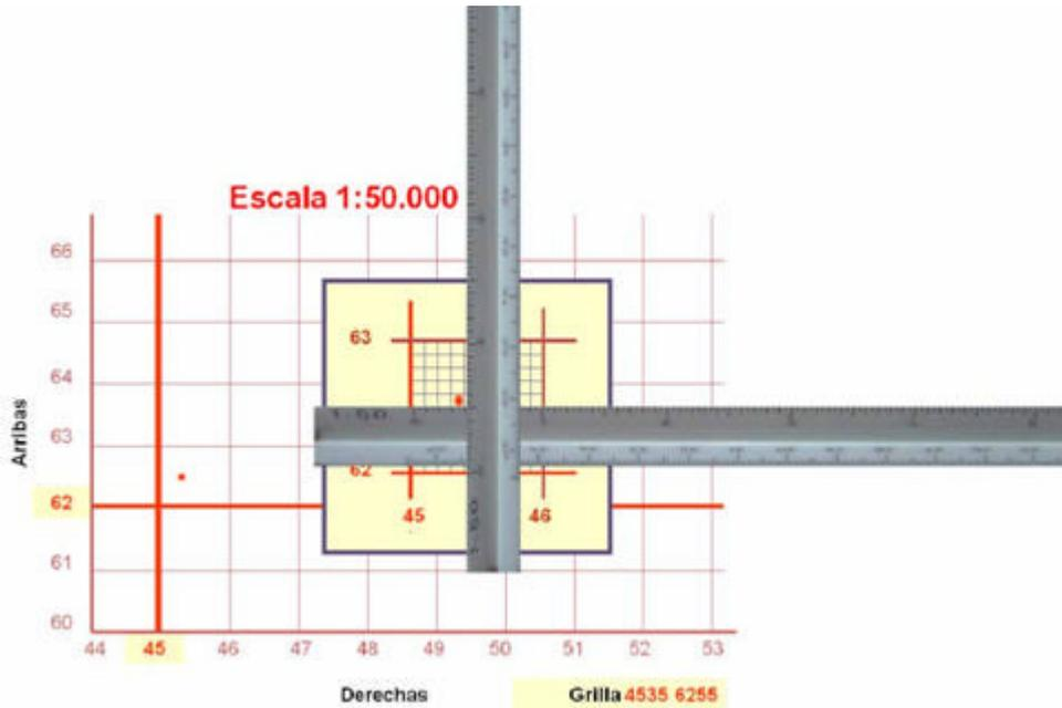
Determinación de las coordenadas de un punto a escala 1: 50.000 (Fig. 66)
