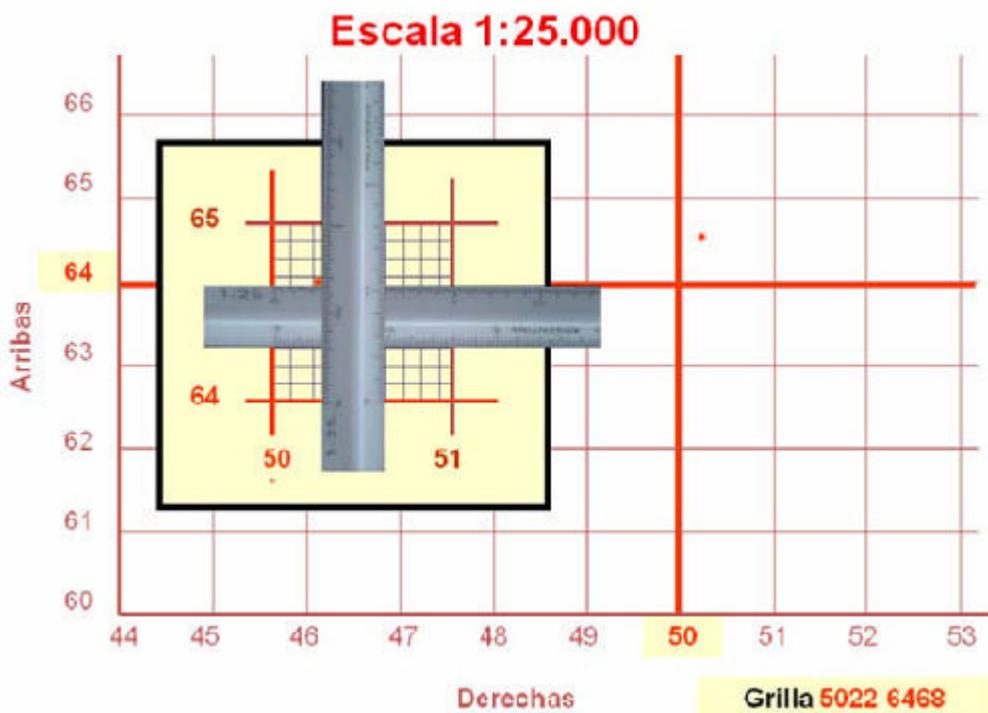
Determinación de las coordenadas de un punto a escala 1: 25.000 (Fig. 67)
