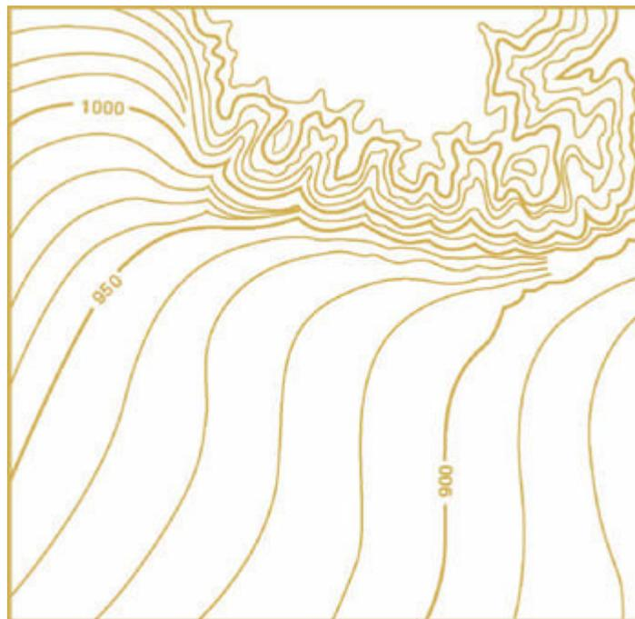
Figura 78: Pase de la equidistancia 10 a 25 m por cambio brusco de pendiente.
