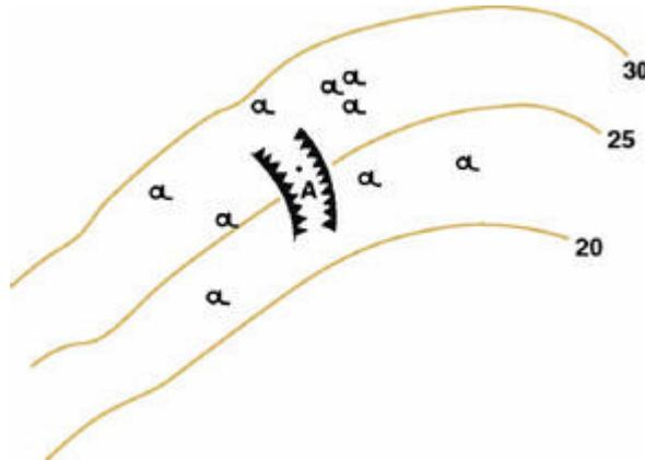
Figura 112: El punto se encuentra en una zanja sin cota interior.
