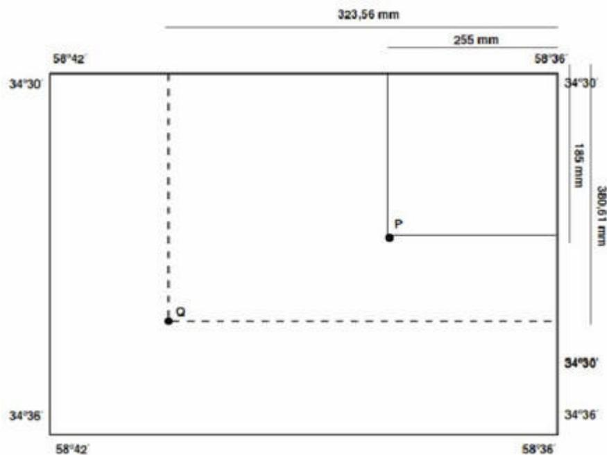
Localización de puntos mediante coordenadas geográficas (Fig 51)
