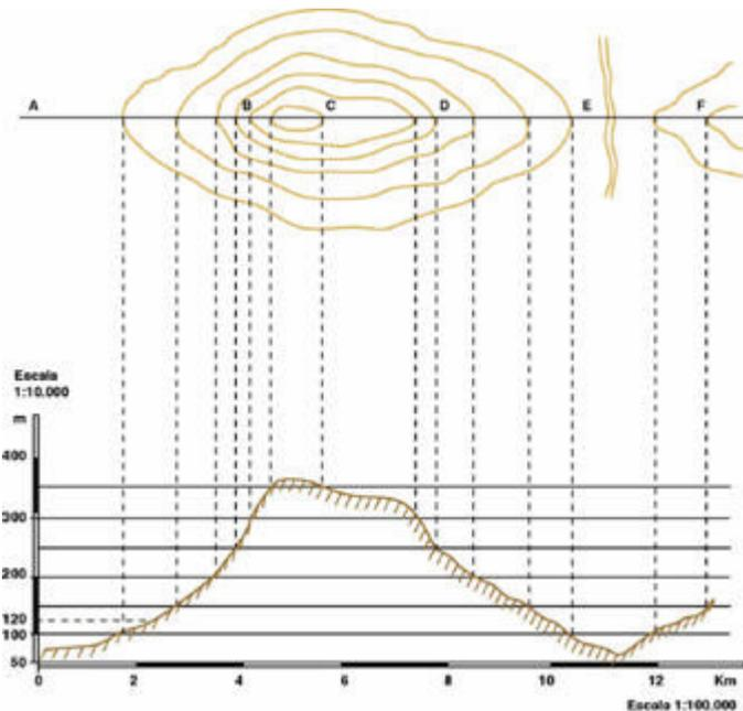
Figura 114: Construcción gráfica de un perfil.
