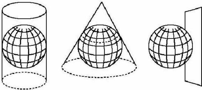
Proyección cilíndrica, cónica y acimutal. Fig(s) 1-2-3
