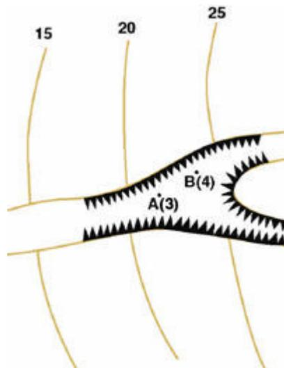
Figura 113: El punto se encuentra en una zanja con cota interior.
