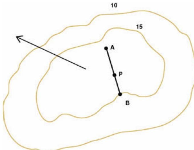
Figura 109: El punto se encuentra dentro de una curva cerrada con un punto acotado en su interior.
