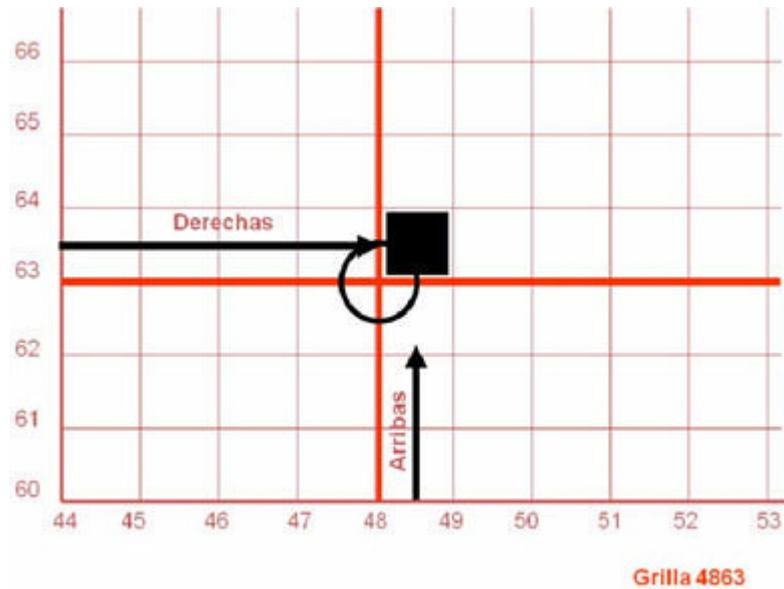
Determinación de las coordenadas de un punto con precisión 1000 metros (Fig. 62)
