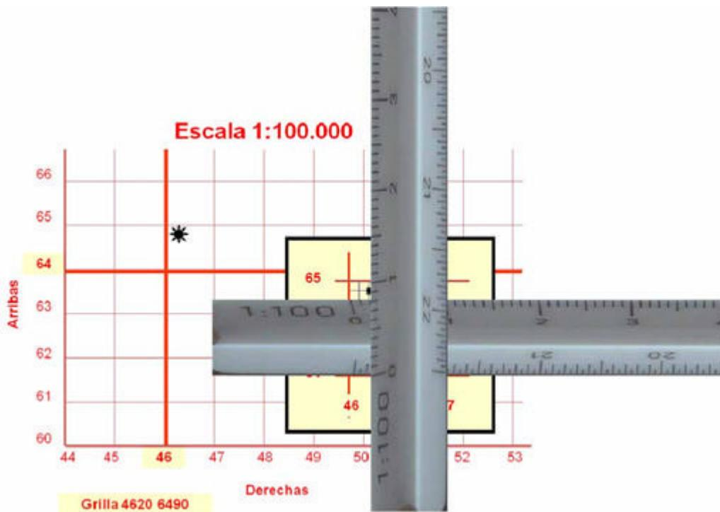
Determinación de las coordenadas de un punto a escala 1: 100.000 (Fig. 65)
