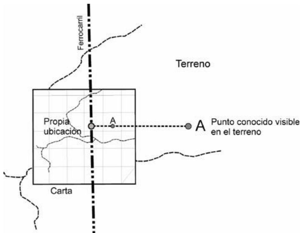
Figura 128: Método de la intersección modificada.
